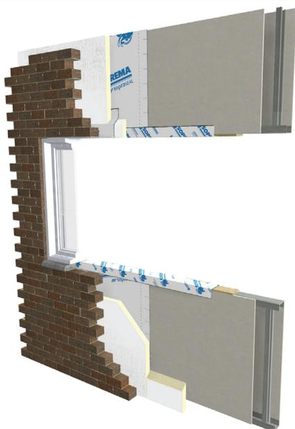
La membrane pare-air/vapeur autocollante SOPRASEAL STICK FLASHPRO HT est le ruban d'étanchéité le plus polyvalent. Flexible et mince, elle peut être utilisée au périmètre des ouvertures mais aussi comme membrane intramurale et membrane de transition.
