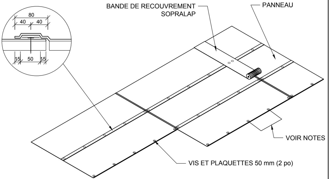
NOTE 1 : LES VIS ET PLAQUETTES DOIVENT ÊTRE INSTALLÉES À L'INTÉRIEUR ET AU **CENTRE DU CHEVAUCHEMENT SEULEMENT**.
