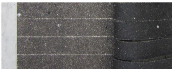
O calor gerado na cura do concreto ativa o processo de adesão entre a face superior da manta, constituída por betume modificado SBS, coberto com uma areia de formulação patenteada.
