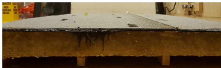
Spécimen de toit de laine minérale après chauffage
