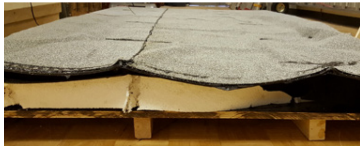
Spécimen de toit EPS après chauffage
