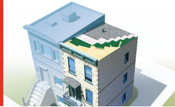
Membrane de finition autocollante dont la surface est recouverte de granules. Elle est utilisée comme membrane de finition dans les systèmes d'étanchéité monocouches et bicouches pour des toitures à faible pente.
