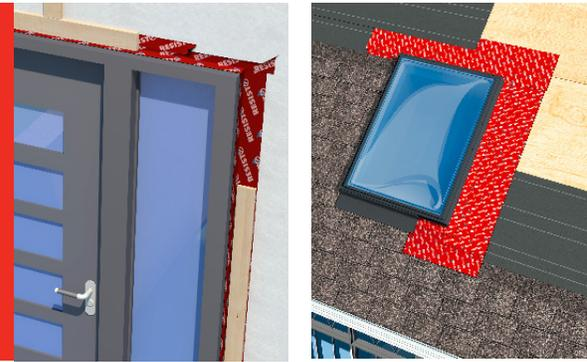
Membrane autocollante utilisée pour réaliser l'étanchéité autour des portes et des fenêtres.
