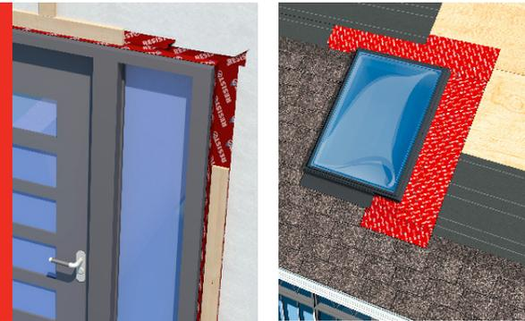
Membrane autocollante composée d'un bitume élastomère SBS de 1,0 mm (40 mils) d'épaisseur et d'un tissé de polyéthylène trilaminaire. La sous-face est composée d'une pellicule siliconée facilement détachable. Elle assure l'étanchéité à l'air et à la vapeur des contours de portes et de fenêtres ainsi que des détails de toitures.
