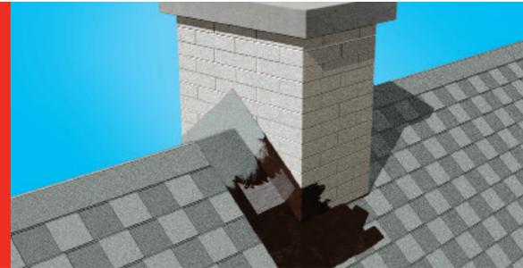
ARMATURE POUR DÉTAILS RESISTOFLASH est un non-tissé aiguilleté constitué à 100 % de fibres de polyester. Ce voile haute performance est fabriqué sans liant chimique. ARMATURE POUR DÉTAILS RESISTOFLASH est utilisé en combinaison avec la MEMBRANE D'ÉTANCHÉITÉ LIQUIDE RESISTOFLASH. Son grand pouvoir d'absorption permet un mouillage rapide facilitant l'imprégnation dans la MEMBRANE D'ÉTANCHÉITÉ LIQUIDE RESISTOFLASH.
