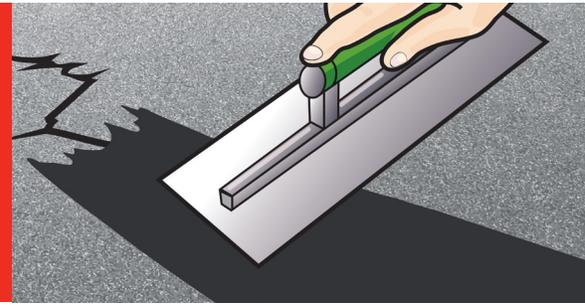
Le MÉLANGE DE NIVELAGE est conçu pour colmater les fissures et les joints de dimension moyenne ainsi que pour corriger de légères dépressions sur les surfaces asphaltées. Il prévient la détérioration des surfaces asphaltées causée par l'usure, la pluie et le gel.
