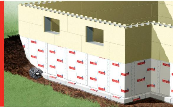
Membrane autocollante spécialement adaptée pour réaliser l'étanchéité des fondations de coffrages isolants (ICF).
