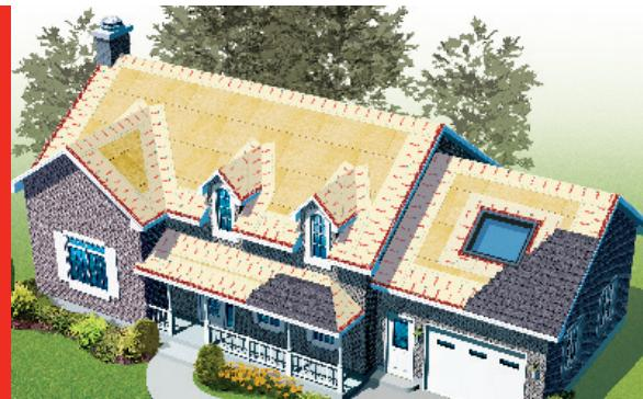
Membrane de sous-toiture autocollante reconnue pour sa performance sous les toits de tôle, comme membrane de périmètre sous le bardage d'asphalte ou en système monocouche. Elle est conçue pour supporter des variations de température de -45 °C à 126 °C (-49 °F à 260 °F).
