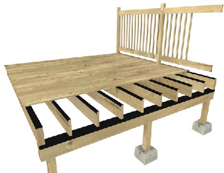
Membrane d'étanchéité autocollante pour les solives qui prévient la pourriture du bois de charpente sous les planchers extérieurs tels que les patios et les balcons. Le rouleau de 10 cm (4 po) est idéal pour les solives de 5 cm (2 po) de largeur, tandis que le rouleau de 23 cm (9 po) est utilisé sur les solives doubles au périmètre de la structure et pour étanchéifier la jonction entre le mur de la maison et le patio.
