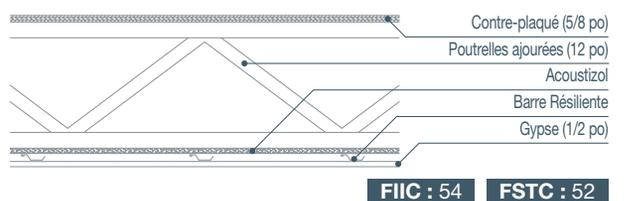
**FIIC**: Indice d'isolement aux bruits d'impact (Field Impact Insulation Class)
