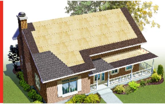
Membrane de sous-toiture clouée avant la mise en place du revêtement de toiture. RESISTOFLEX permet, avec une seule bande, d'excéder d'au moins 300 mm la face intérieure du mur extérieur, tel que prescrit dans le Code national du bâtiment, étant donné sa largeur de 1,12 m(44 po).
