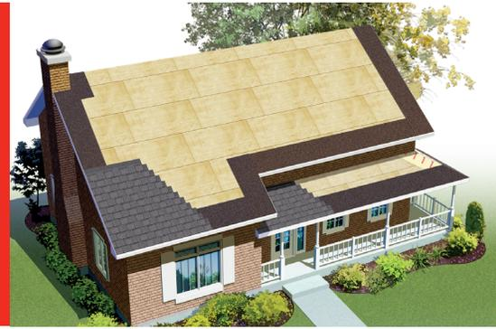
Membrane de sous-toiture autocollante composée d'une armature de voile de verre et dont la surface sablée est antidérapante.
