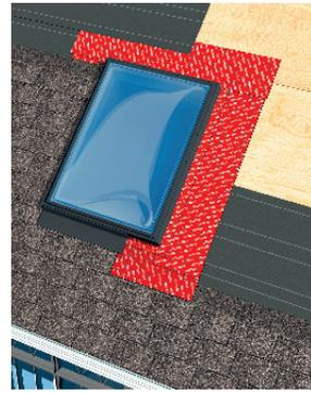
Membrane autocollante utilisée pour réaliser l'étanchéité autour des portes et des fenêtres.
