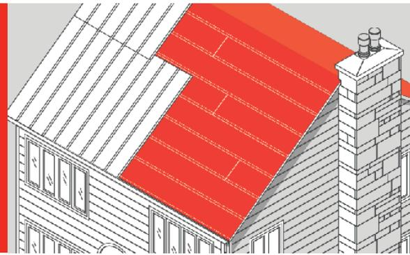
Membrane de sous-toiture autocollante **reconnue pour sa performance sous les toits de tôle**, comme membrane de périmètre sous le bardeau d'asphalte ou en système monocouche. Elle est conçue pour supporter des variations de température de -45 °C à 126 °C (-49 °F à 260 °F).
